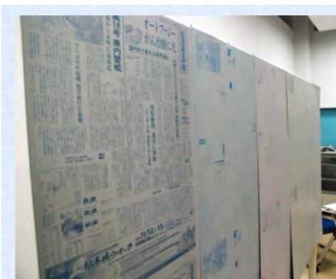
これが、新聞を印刷するために使う刷版です。信毎長野本社の編集局から届く「紙面情報」を、厚さ0.3mmのアルミ製の板に焼きつけます。黒、青、赤、黄の4つの色ごとにつくられ、文字や写真の部分にはインキ(油性)がつき、ほかの部分には水がつく特別な加工がされています。油と水がはじき合う性質を利用して、きれいな印刷ができます。
